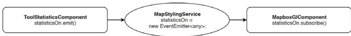
Abbildung 4.3: Übermitteln der Daten an die Komponenteklasse „MapboxGlComponent“ (EIGENE)
