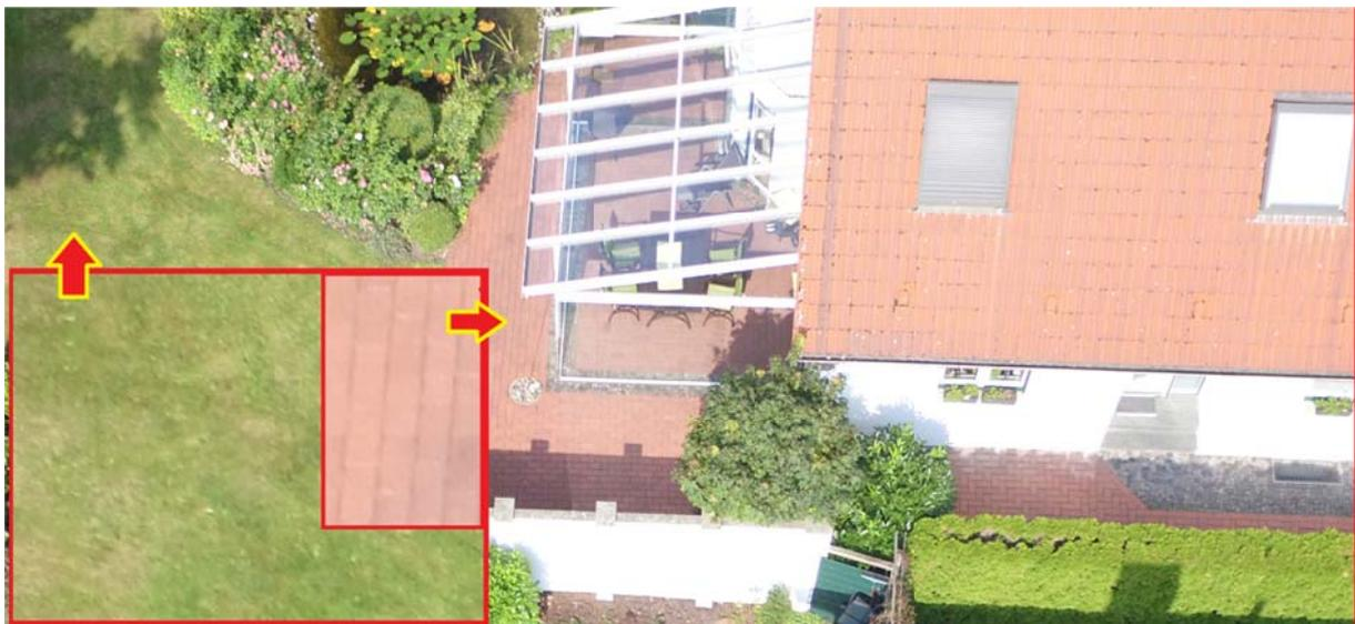
Abbildung 21 Unschärfe und Überbelichtung im Befliegungsgebiet *Quelle: Eigene*
