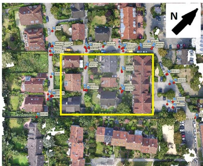
**Abbildung 18 Messgebiet -Passpunktverteilung - Befliegungsfläche** *Quelle: Eigene*
