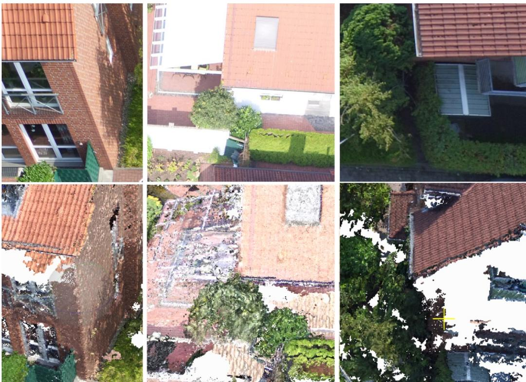
Abbildung 26 Vergleich dichte Punktwolke vs Bilder *Quelle: Eigene*
