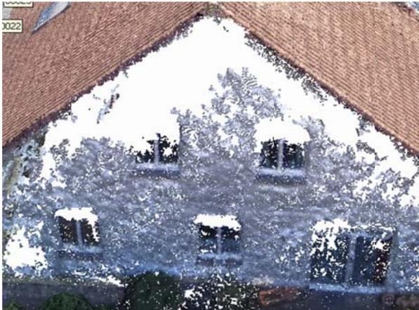
Abbildung 27 Dichtepunktwolke der Fassade
