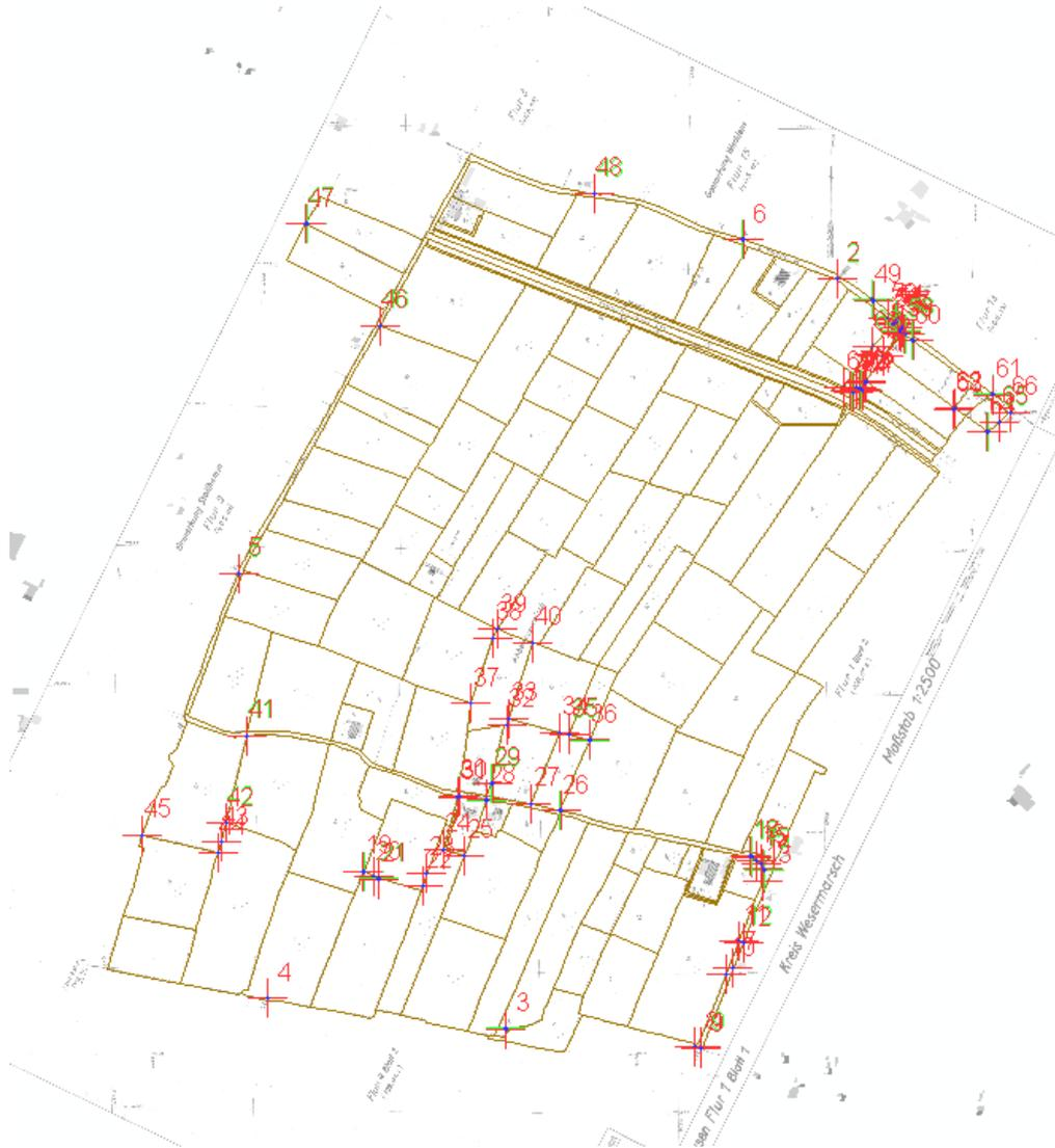
Abbildung 4.5: Passpunktgrundlage im Untersuchungsgebiet ohne manuell gesetzte Passpunkte aus dem Luftbild [Eigene Abbildung]
