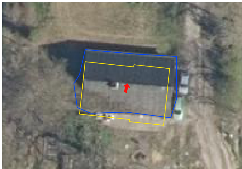
Abbildung 16: Deep Learning-basierte Methode zur Verbesserung der geometrischen Genauigkeit der Liegenschaftsgrafik
