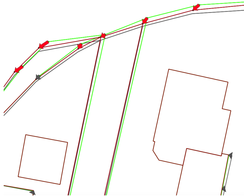
Abbildung 36: Differenzen zwischen der gebäudebasierten Homogenisierung und der Basishomogenisierung bei Nachbarschaftsbrüchen
