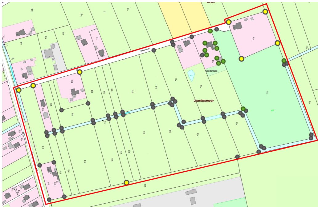
Abbildung 19: Bestimmung von Passpunkten in passpunktfreien Bereichen im Untersuchungsgebiet Colinghorstmoor
