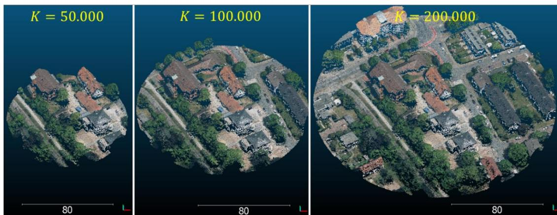
Abbildung 52: Batches mit verschiedener Punktzahl. Links: 50.000; Mitte: 100.000; Rechts: 200.000
